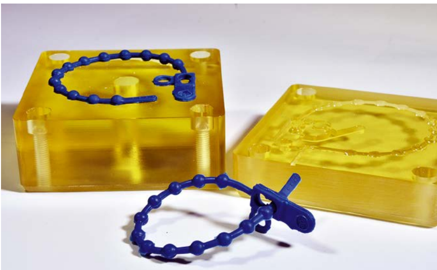
Zielvorgabe Kabelbinder: Nach knapp 55 Stunden fallen die fertigen Bauteile aus den 3D-gedruckten Werkzeugeinsätzen. (© Hochschule Reutlingen)
